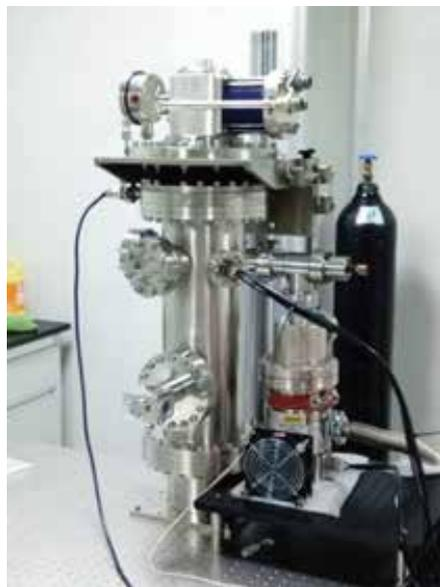
超低振动超高真空低温恒温器
